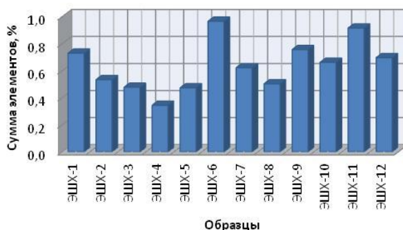
Рис. 7. Массовая доля элементов P, Si, Mn, Mo, S, Al, Cr, Ni, W, Ti, V, Cu, Co, Nb, Zr в слитках (остальное Fe)
